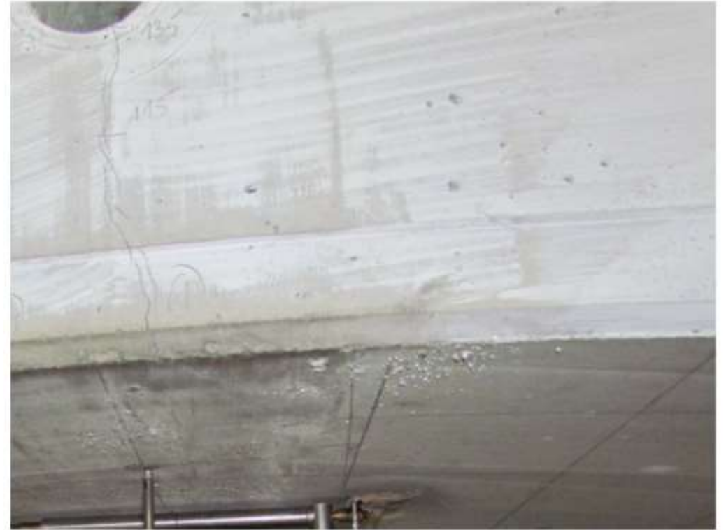
Fot. 13 Segment E - pierwsza powstająca rysa nr 1 przy sile 115 kN
